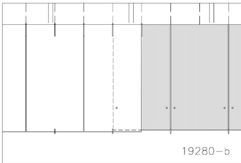
Fig. 15: Tweede laag leien van de eerst rij leien
