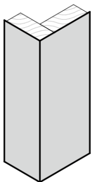
Protection de l'angle extérieur
