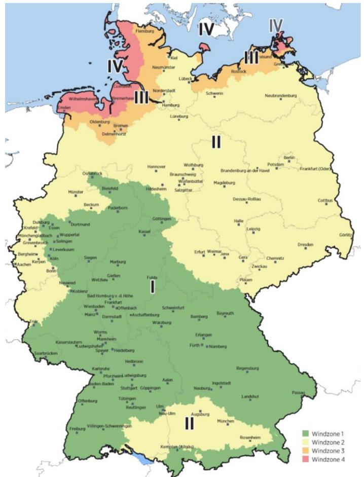
Windzonenkarte nach Eurocode 1 (DIN EN 1991-1-4/NA). Mit der Systematik können Bluclad Fassaden von Gebäuden in den Windzonen (WZ) I - IV einfach berechnet werden.
