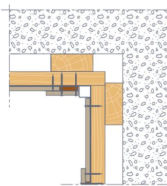
En pose verticale comme en pose horizontale sur chevron bois, la fixation de la dernière lame Cedral Lap peut être réalisée à l'aide des vis colorées à tête bombée Cedral Board. La vis est pourvue d'ailettes de fraisage le long de sa tige, rendant ainsi superflus les travaux de perçage. La vis doit être positionnée à 25 mm minimum de la rive latérale de la lame.
