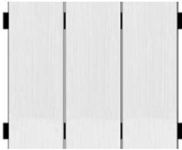
Les lames sont fixées les unes à côté des autres, avec un joint ouvert pouvant aller de 3 à 10mm. Une lame d'air ventilée toute hauteur de 20mm mini entre le nu externe de l'isolant ou de la paroi support (en l'absence d'isolant) et la face arrière du réseau d'ossature horizontal supportant la lame Cedral Lap doit être ménagée. Un « profil joint filant » disponible dans tous les coloris peut également être utilisé pour réaliser les joints fermés entre les lames.
