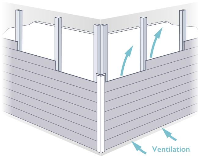
Sur toute la hauteur du bardage, une lame d'air continue de 20mm minimum sera ménagée entre l'isolant et la face arrière du bardage Cedral. On assurera des entrées et sorties d'air continues, en parties basses et en parties hautes du bardage, avec reprises des orifices de ventilation en encadrements de baies (appuis et linteaux).
