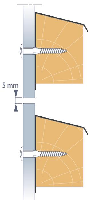
**Un joint bout à bout droit ouvert de 5 mm pour une pose standard** (en milieu non soumis à de fortes intempéries: fond de cuvette entouré de collines sur tout son pourtour et protégé ainsi pour toutes les directions du vent ; terrain bordé de collines sur une partie de son pourtour correspondant à la direction des vents les plus violents et protégé pour cette seule direction du vent, plaine ou plateau pouvant présenter des dénivellations peu importantes étendues ou non).
