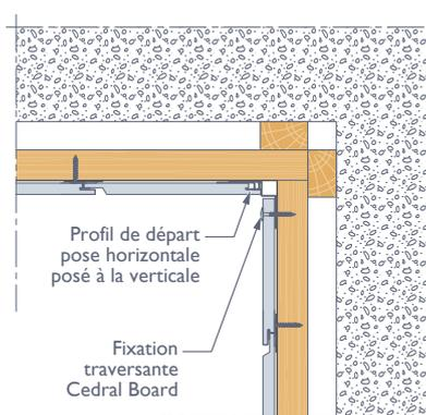
La dernière lame Cedral Click est fixée à l'aide des vis colorées à tête bombée Cedral Board. La vis est pourvue d'ailettes de fraisage le long de sa tige, rendant ainsi superflus les travaux de pré-perçage. La vis doit être positionnée à 25 mm minimum de la rive latérale et de la rive transversale de la lame.
