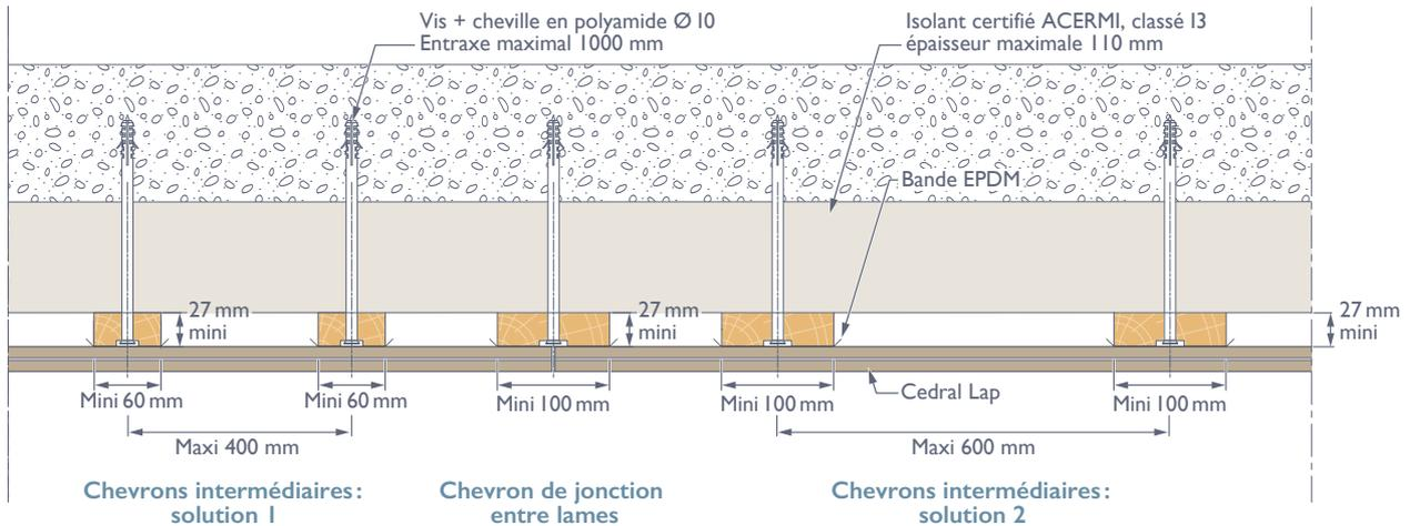
1. Le montage débute par le bas de la façade, à 150 mm par rapport au sol (sol meuble, sol dur, terrasse...). Après la pose de la grille d'aération anti-rongeurs, le profil de départ Cedral Lap est fixé, parfaitement de niveau, sur les chevrons d'ossature. Des vis à tête fraisée peuvent être utilisées.
