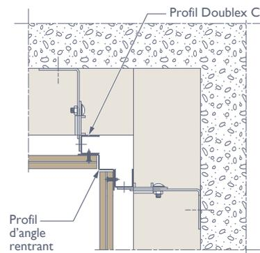
**Exemple arrêt d'extrémité (avec isolant) avec le profil de finition laqué**
