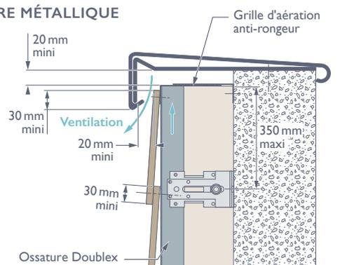
**Exemple angle sortant avec profil d'angle sortant symétrique Cedral Lap pose horizontale (avec isolant)**
