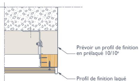
**avec le profil d'arrêt latéral long + épingle de raccord**
