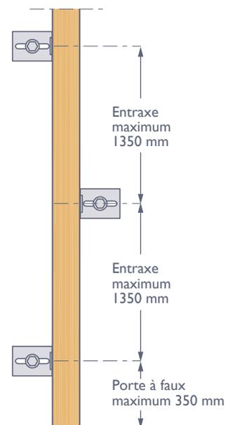
Dans le cas d'une pose directe sans isolant sur le mur support (béton ou maçonnerie d'éléments enduits) ou d'une pose sur COB, les fixations\* des chevrons ont un entraxe de 1 m maximum (même entraxe pour les cales intermédiaires).
