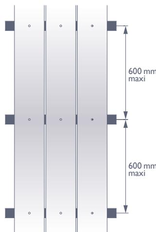
Une fixation centrée n'est possible qu'en employant des vis auto-forieuses (auto-perceuses) dont la couleur des têtes (diamètre mini 12 mm) peut être assortie à celle de la lame Cedral Lap.
