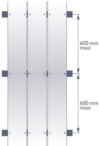
En partie courante des lames, les fixations doivent être placées à 600 mm les unes des autres dans la hauteur.
