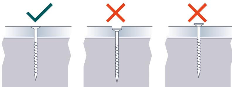
La fixation des lames avec vis bois permet de s'affranchir du pré-perçage.
