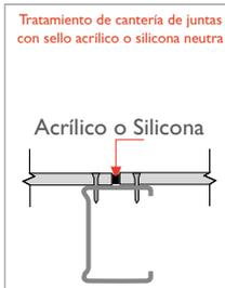
Para tratamiento de juntas verticales en estructura de madera o metal, se recomienda mantener una separación mínima entre placas de 2 mm.
