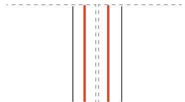
7. Fijación mecánica recomendada: utilizar 4 tornillos arriba y 4 tornillos abajo.
