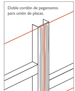
Estilo de aplicación de adhesivo en montante de unión de placas.
