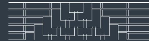
Pose horizontale à recouvrement double
