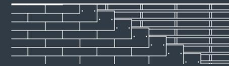
Pose inclinée à recouvrement double
