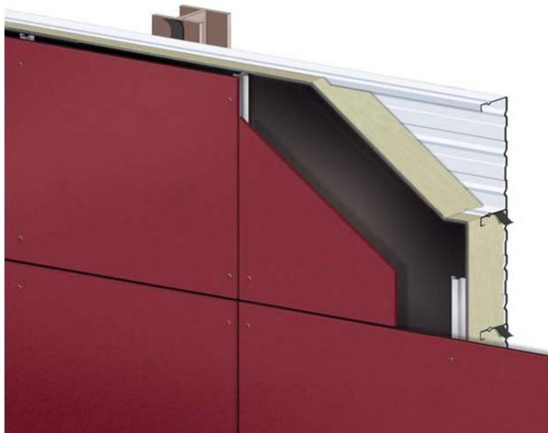
*Figure 2 – Schéma de principe avec pare-pluie synthétique*
