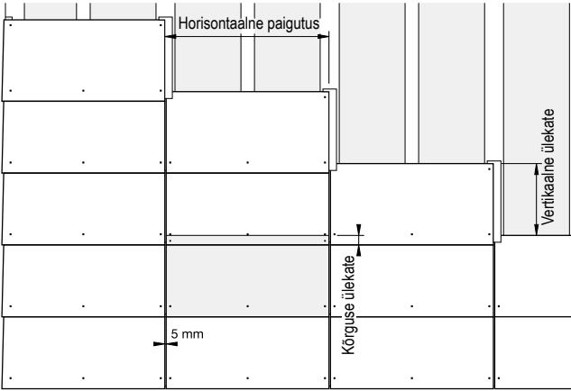
Näide: 60 × 30 cm fassaadiplaatide vertikaalne kate
