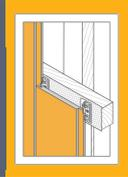
Si la distance X est inférieure à l'épaisseur de la latte + 45 mm, mais au moins de 46 mm, une cale supplémentaire peut être fixée au-dessus (ou en dessous) du raccord d'angle avec la structure portante horizontale. Ces cales supplémentaires doivent également être protégées contre la pénétration de l'humidité à l'aide d'une bande en PE.
