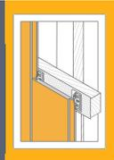
Une ouverture de ventilation nette d'au moins **100 cm<sup>2</sup>/mc** doit être prévue dans le haut et le bas de la façade, mais aussi au niveau des ouvertures de portes et de fenêtres, pour assurer un flux d'air naturel ininterrompu derrière les lames de façade.
