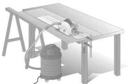
Lors du traitement de la lame de façade, celle-ci doit être suffisamment soutenue afin d'éviter qu'elle ne se plie. La table de sciage doit être très stable et ne peut pas vibrer. Pour un trait de scie parfait, la lame de façade ne doit être soumise à aucune vibration ni contrainte.
