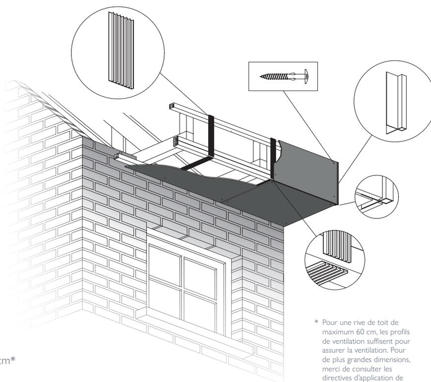
\* Pour une rive de toit de maximum 60 cm, les profils de ventilation suffisent pour assurer la ventilation. Pour de plus grandes dimensions, merci de consulter les directives d'application de Cedral Board.
