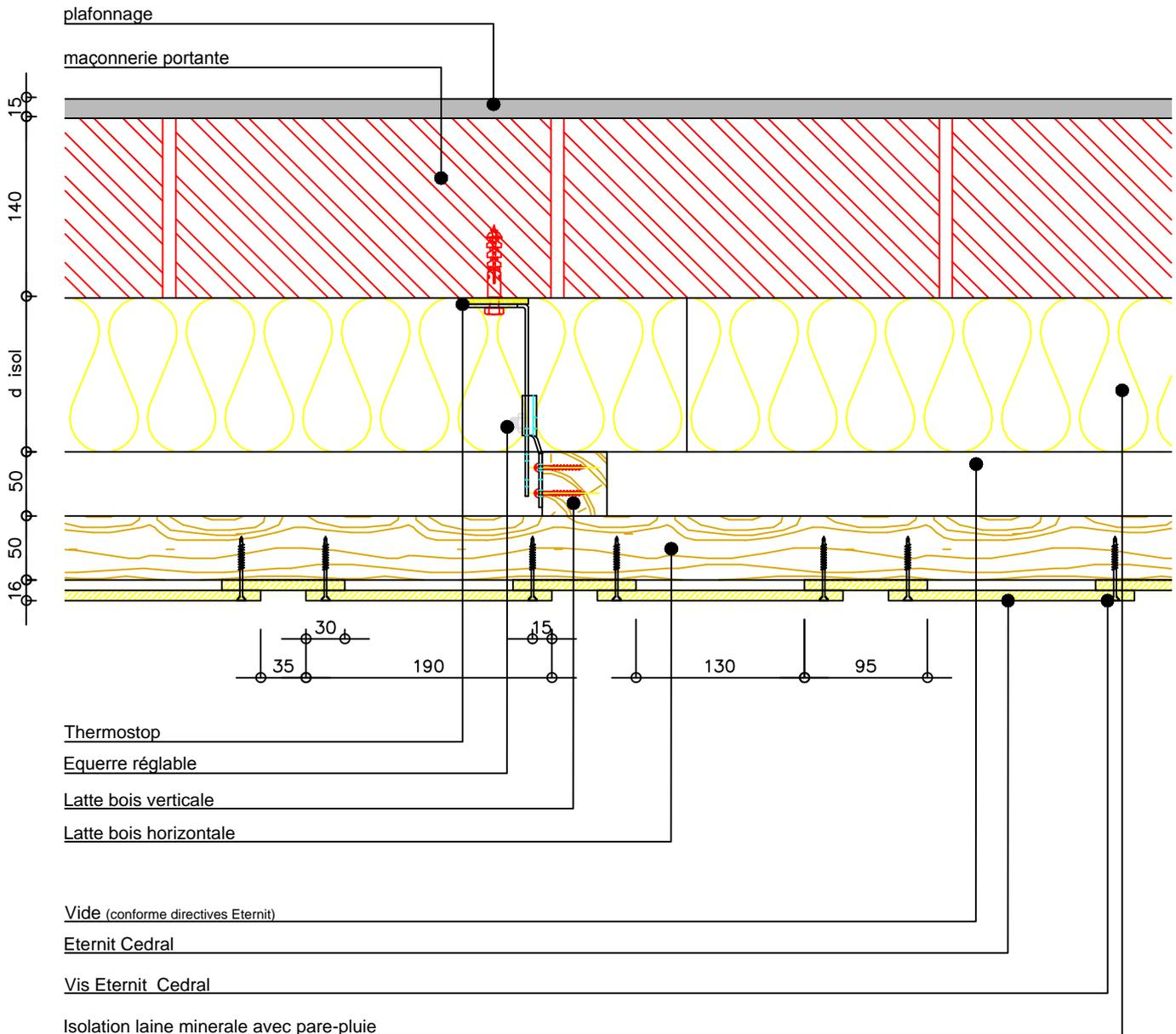
Le nœud constructif est PEB accepté et valable pour des MAISONS BASSE ENERGIE si les dimensions et les matériaux sur le dessin sont respectés.
