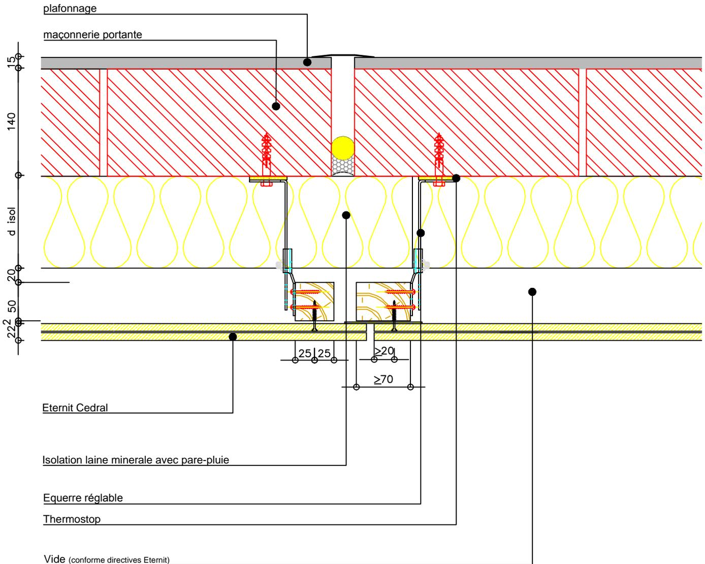
Le nœud constructif est PEB accepté et valable pour des MAISONS BASSE ENERGIE si les dimensions et les matériaux sur le dessin sont respectés.
