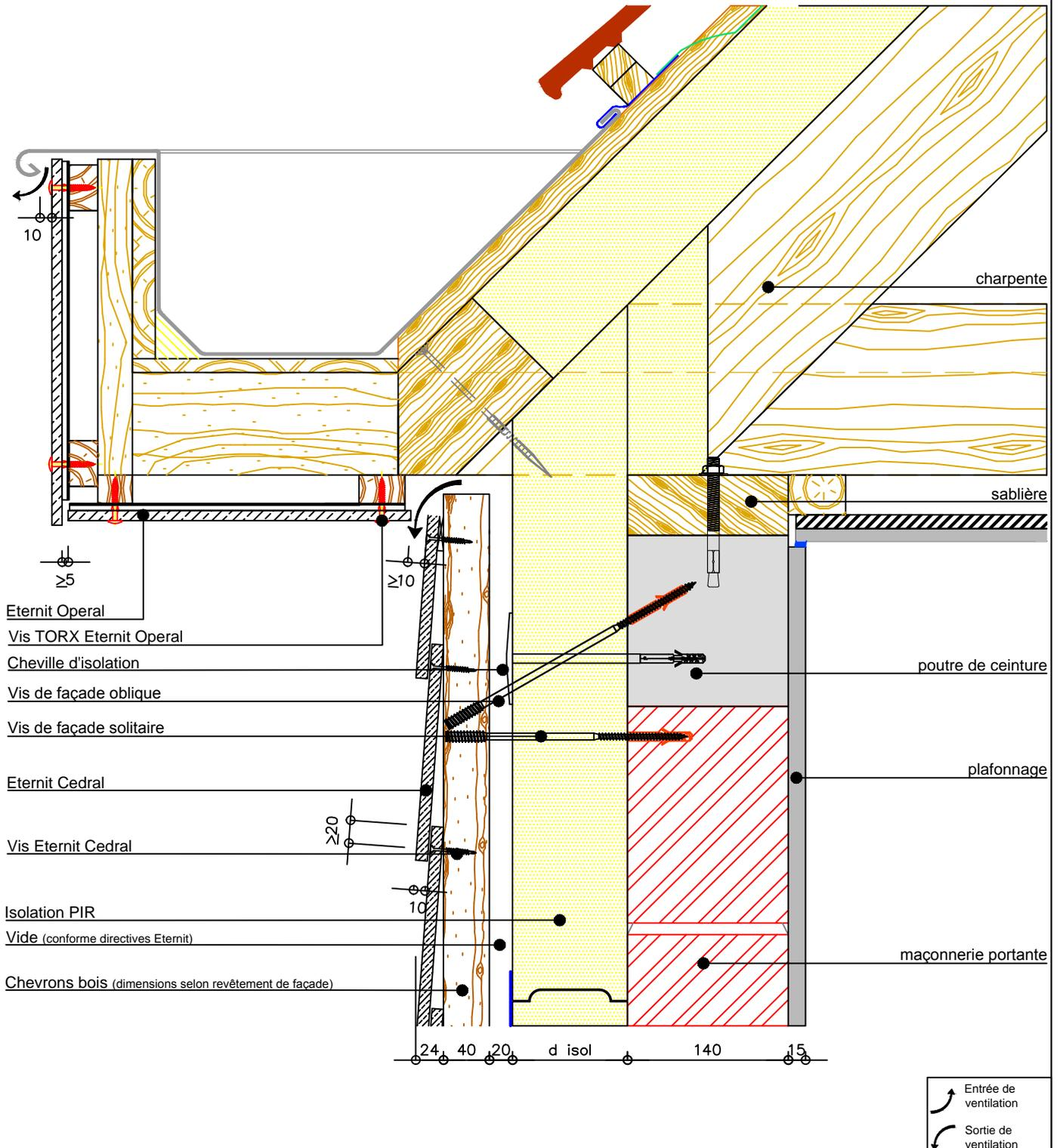
Le nœud constructif est PEB accepté et valable pour des MAISONS BASSE ENERGIE si les dimensions et les matériaux sur le dessin sont respectés.
