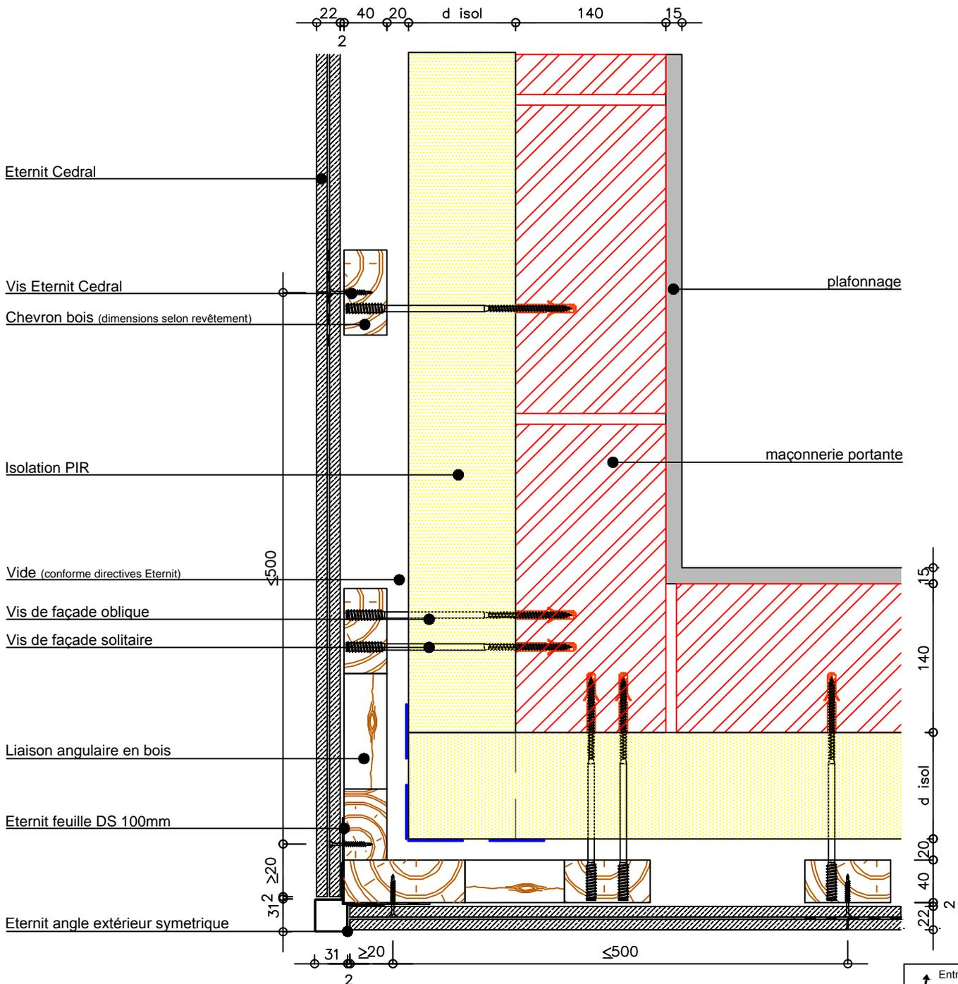
Le nœud constructif est PEB accepté et valable pour des MAISONS BASSE ENERGIE si les dimensions et les matériaux sur le dessin sont respectés.
