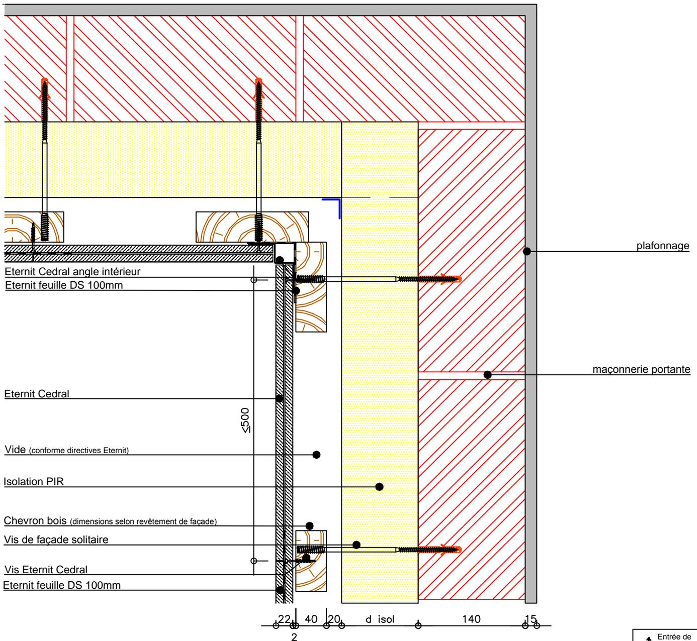
Le nœud constructif est PEB accepté et valable pour des MAISONS BASSE ENERGIE si les dimensions et les matériaux sur le dessin sont respectés.
