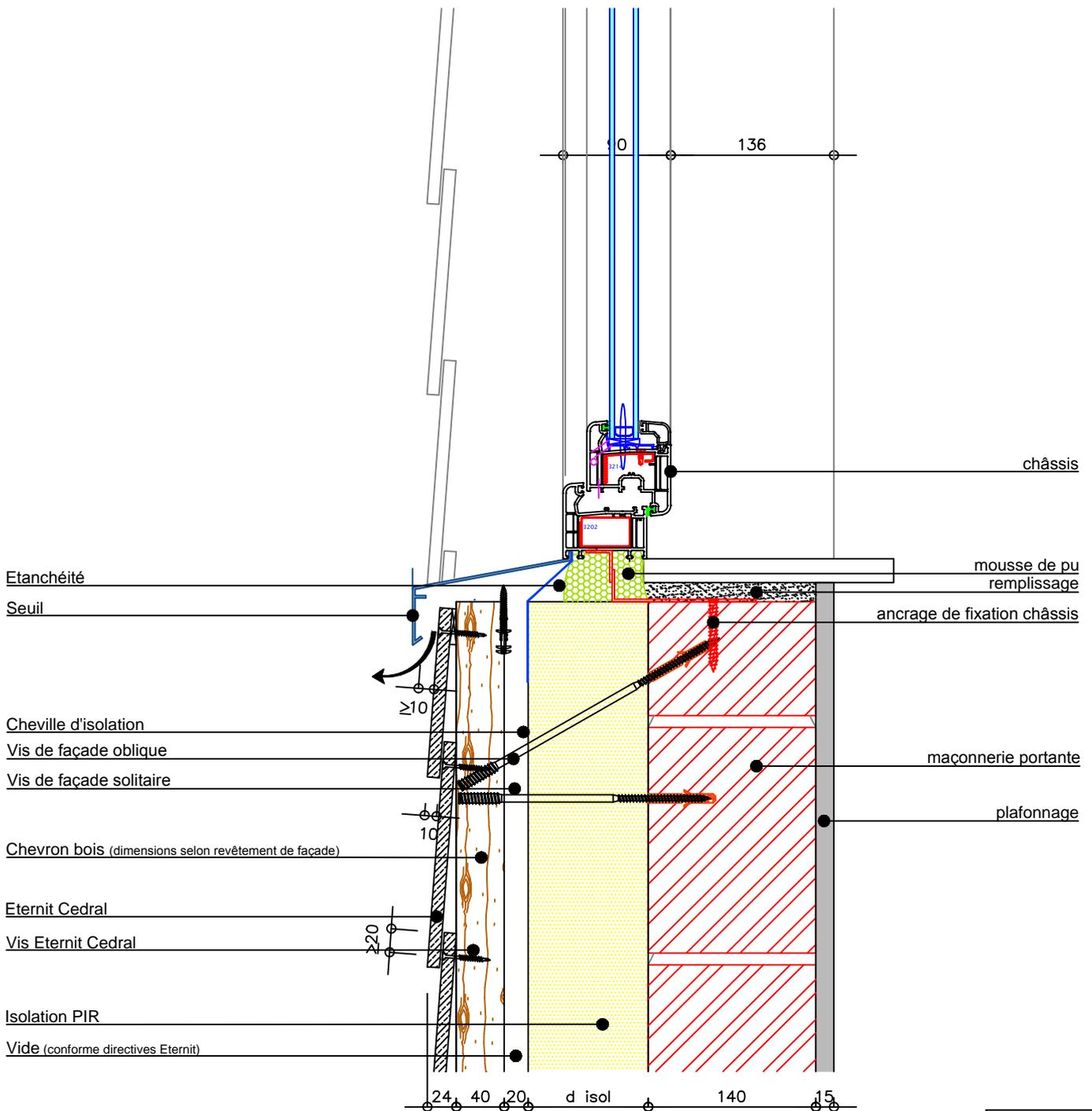
Le nœud constructif est PEB accepté et valable pour des MAISONS BASSE ENERGIE si les dimensions et les matériaux sur le dessin sont respectés.
