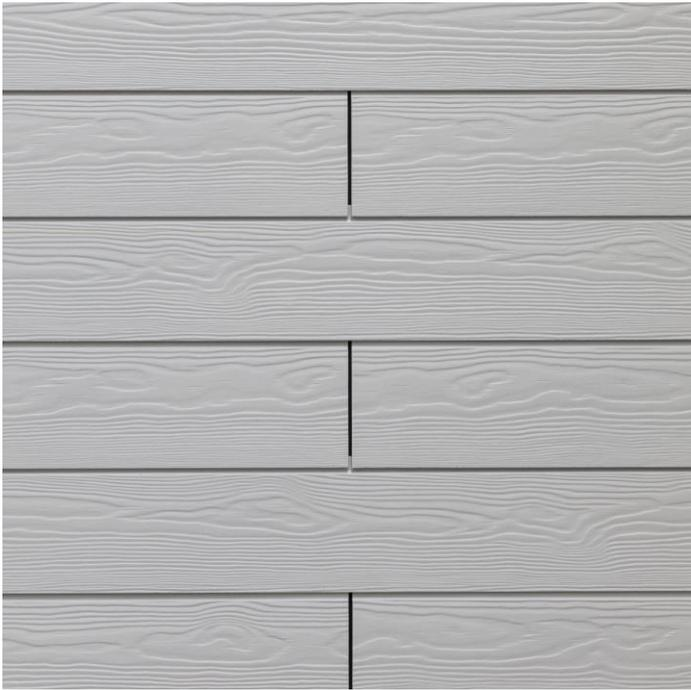
Mit dem Fassadenpanel Cedral Click können ebene Fassadenbekleidungen als horizontale Profilschalung mit Schattennut realisiert werden. Hierzu werden die Faserzementpaneele mithilfe der Cedral Click Klammer und Schraube an der vertikalen Holz-Unterkonstruktion befestigt. So entsteht eine geschlossene Fassadenoberfläche, ohne dass die Befestigungen sichtbar sind.
