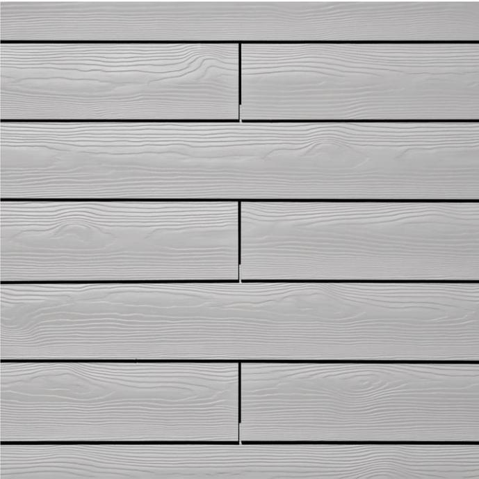
Bei der Verlegung der Fassadenpaneel Cedral Lap als Stülpchalung erfolgt die Verlegung horizontal auf einer vertikal befestigten Traglattung. Die einzelnen vollkantigen Paneele werden übereinander befestigt, wobei das nächste Paneel immer das vorherige überdeckt. Befestigt werden die Paneele nicht sichtbar im Bereich der Höhenüberdeckung mit den Cedral Lap Schrauben 4,0 x 45 mm (Torx 20).
