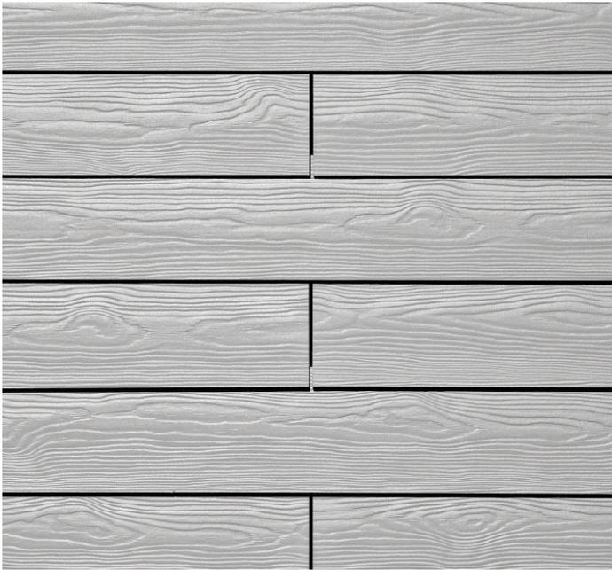
Bei der Verlegung der Fassadenpaneel Cedral Lap als Stülpchalung erfolgt die Verlegung horizontal auf einer vertikal befestigten Traglattung. Die einzelnen vollkantigen Paneele werden übereinander befestigt, wobei das nächste Paneel immer das vorherige überdeckt. Befestigt werden die Paneele nicht sichtbar im Bereich der Höhenüberdeckung mit den Cedral Lap Schrauben 4,0 x 45 mm (Torx 20).
