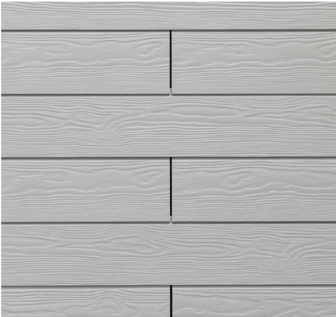
Mit dem Fassadenpanel Cedral Click können ebene Fassadenbekleidungen als horizontale Profilschalung mit Schattennut realisiert werden. Hierzu werden die Faserzementpaneele mithilfe der Cedral Click Klammer und Schraube an der vertikalen Holz-Unterkonstruktion befestigt. So entsteht eine geschlossene Fassadenoberfläche, ohne dass die Befestigungen sichtbar sind.
