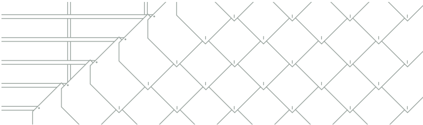
Ardoises en losange - Pose classique
